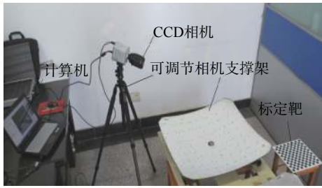
图2 面形检测系统
