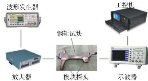
图 2 检测系统示意图
