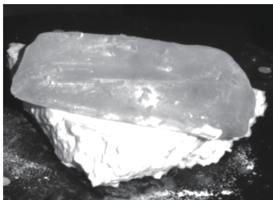
图6 喷涂显影剂的冰形表面
