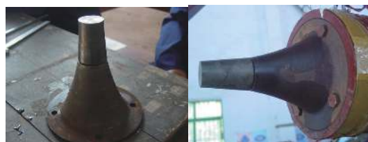
图5 分体式试验后击砧端面情况
