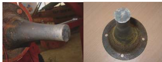
图4 表面硬度提高后两次击砧端面情况
