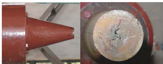
图2 等端面直颈式击砧试验后击砧端面情况
