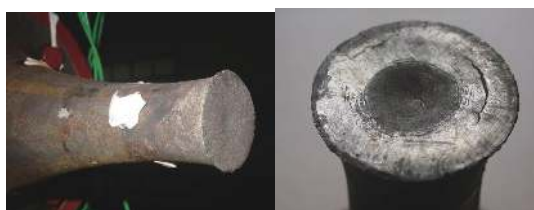
图3 整体调质的两次试验后击砧端面情况
