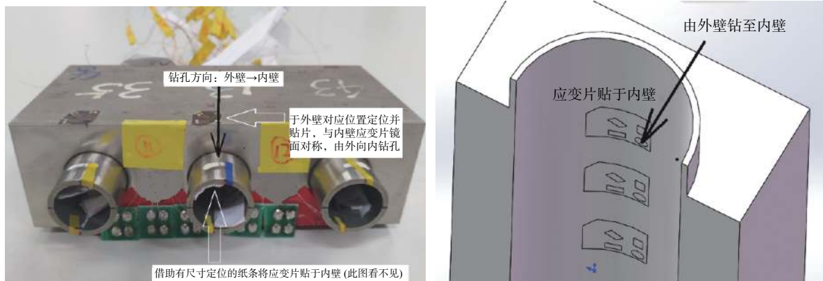
图 1 应用钻孔法测胀管内壁应力
